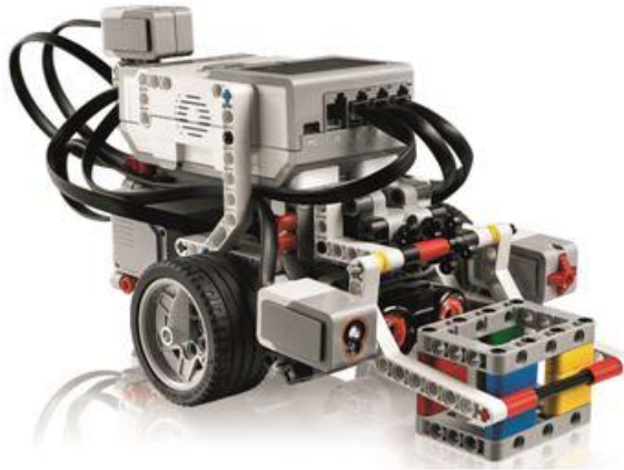
Figura 2 - Robô programável de LEGO conta com 5 motores e 5 sensores
